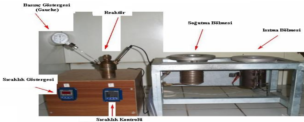
Şekil 3.1. Deneylerde kullanılan reaktör ve ısıtma-soğutma sistemi
