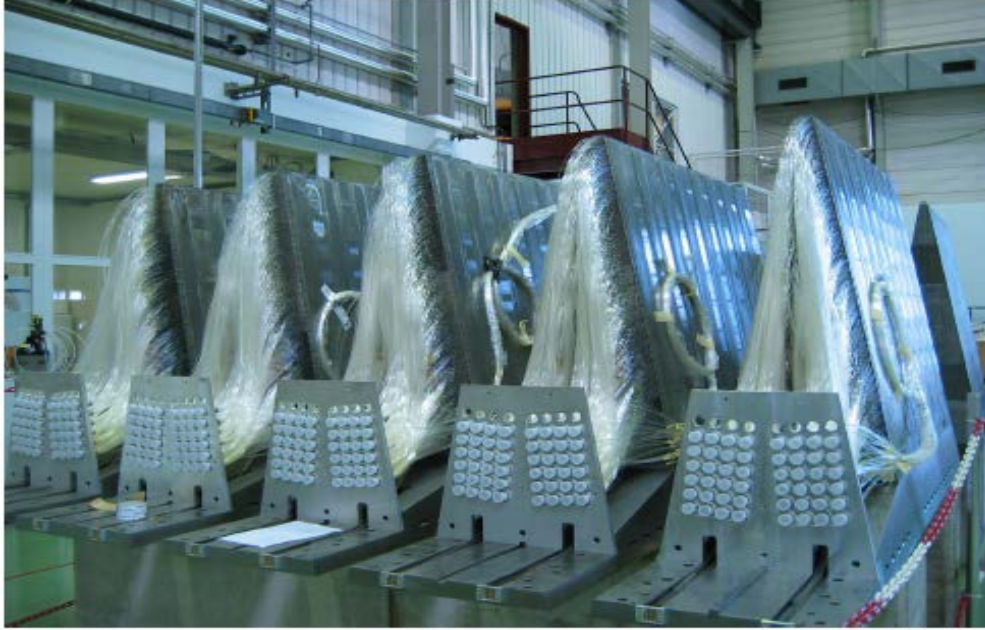
Şekil 3.4. Kuvars fiberlerin yerleştirildiği HF kamalarının bir fotoğrafı (CMS colabration, 2008, JINST 3 S08004, 2008).
