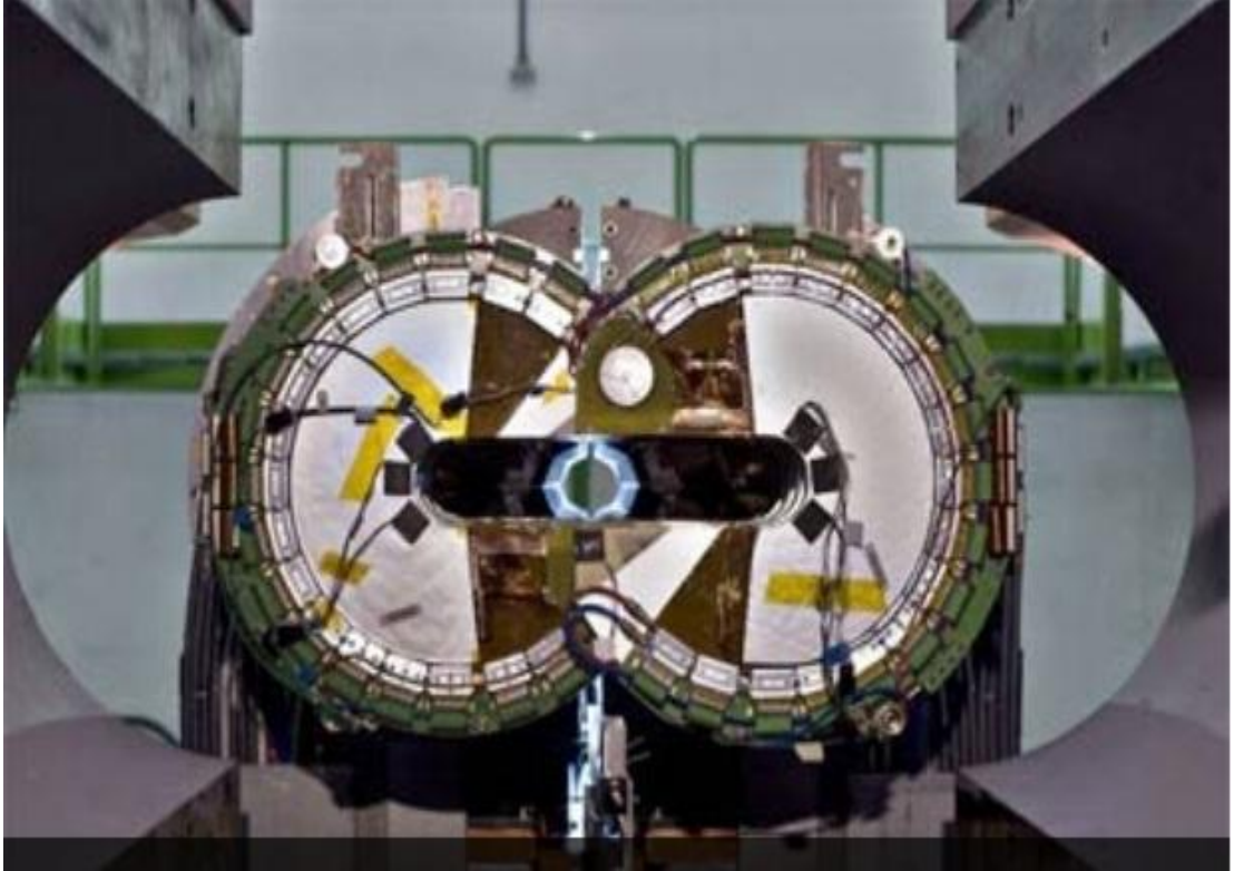
Şekil 2.7. TOTEM T2 detektörünün etkileşim bölgesine dahil edilmesi sırasında çekilmiş fotoğraf.
