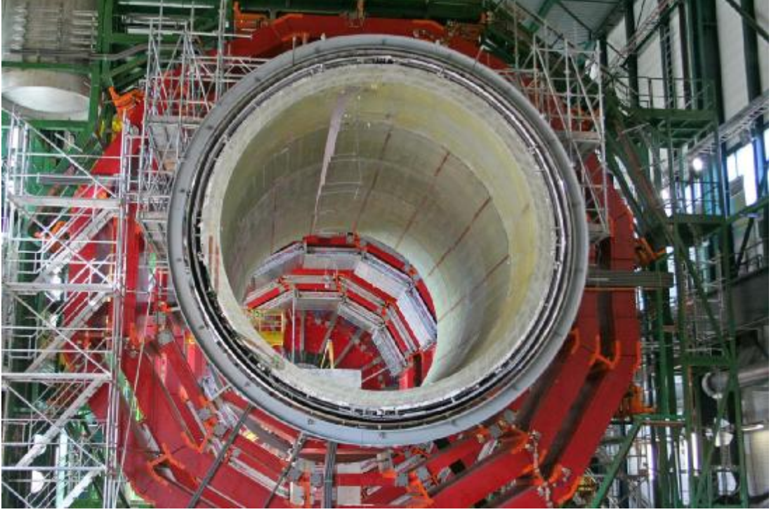
Şekil 2. 17. CMS detektörü içerisinde bulunan süper iletken selenoid mıknatıs.
