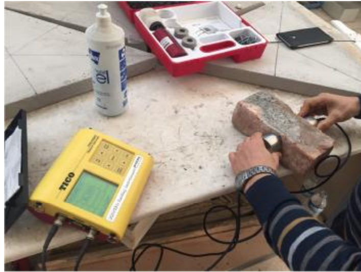
Şekil 4.50. Ultrason test cihazı ile malzeme özelliğinin tespit edilmesi
