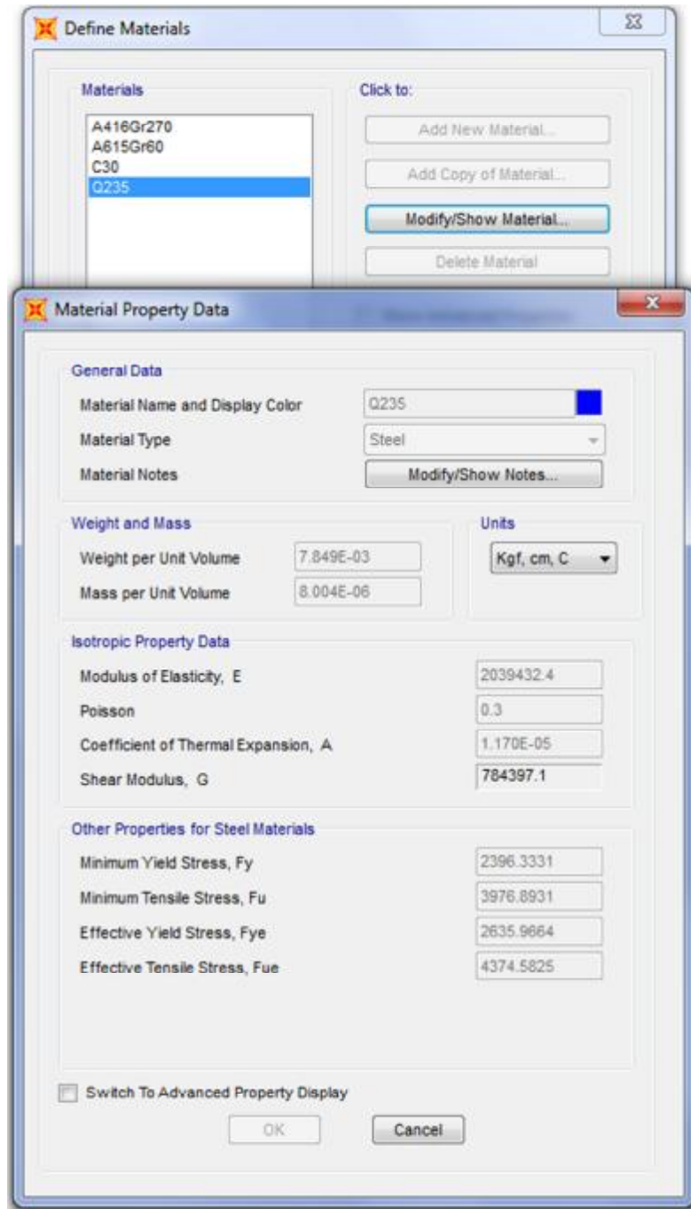
Şekil 4.60. Yakma bacası malzeme özellikleri
