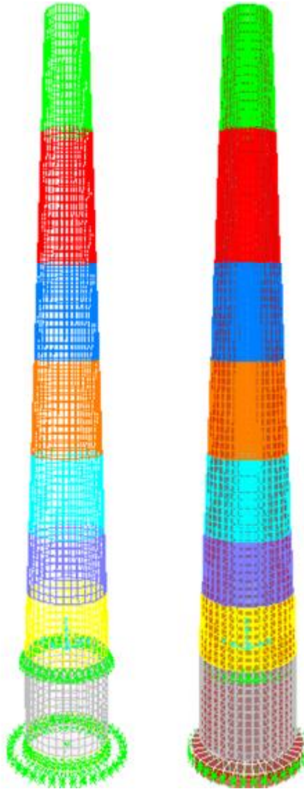
Şekil 4.48. Kangal haddehanesi bacası sonlu elemanlar modeli ve duvar kalınlığının değişimi
