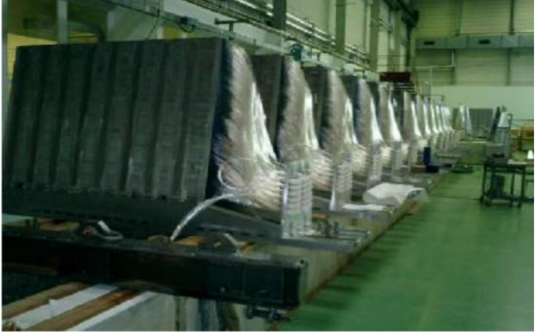
Şekil 4.3. Kuartz fiberlerinin ve FÇT 'lerin yerleştirildiği HF kuleleri ( http://cds.cern.ch/record/946271 ).
