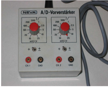
Şekil 3.5. Analog sayısal çevirici için iki kanallı bir ön amplifikatör.
