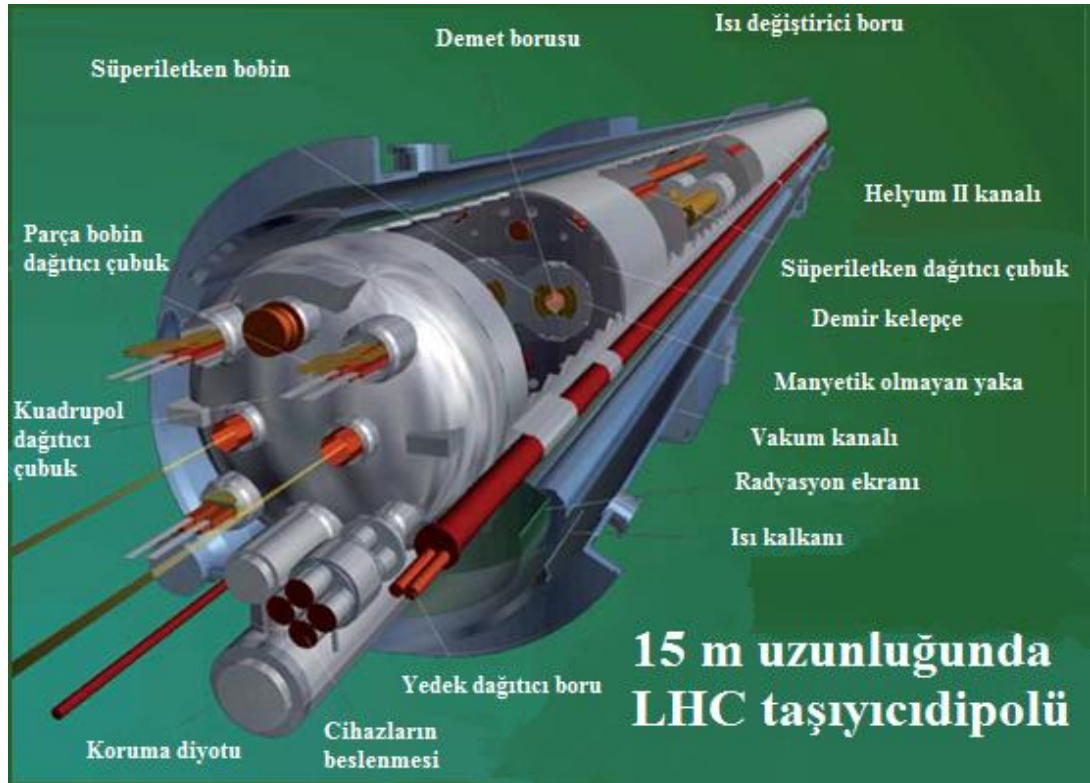
Şekil 3.3. Işın demeti taşıyan taşıyıcı dipolün şematik görünüşü.
