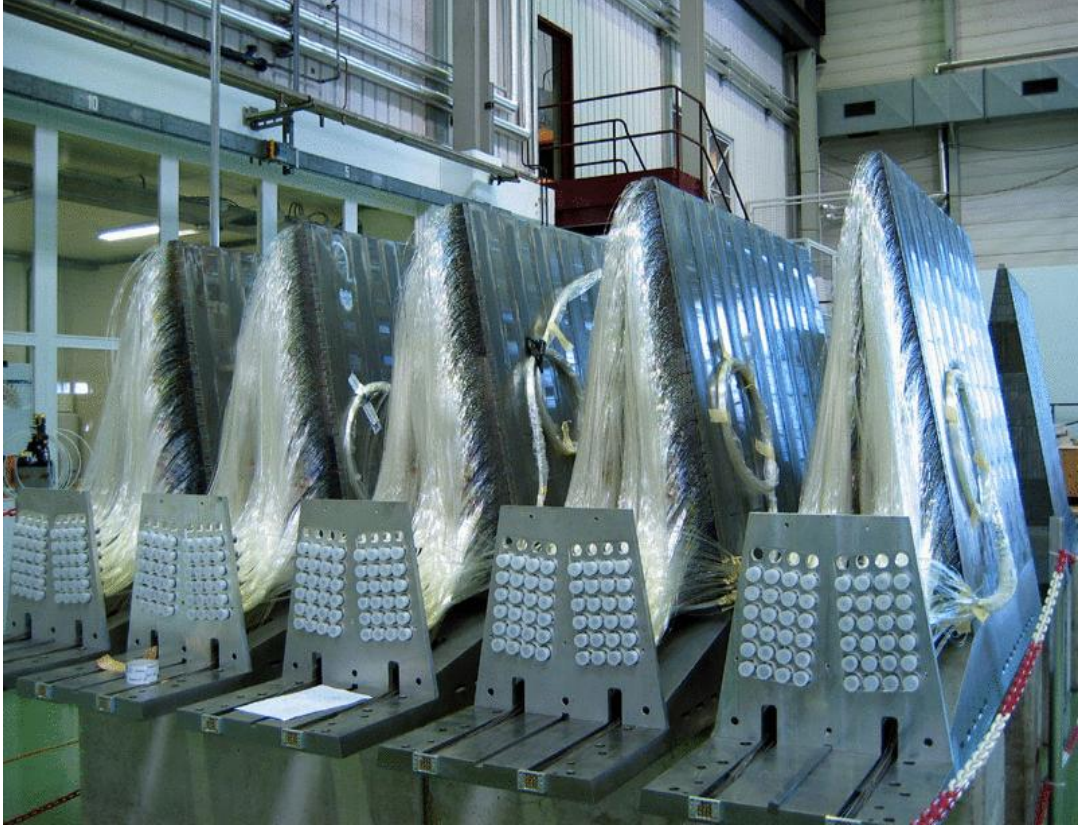
Şekil 4.4. Çelik soğurucunun fiberler ile doldurulması ve montajı sırasında HF dilimlerinin görünüşü.
