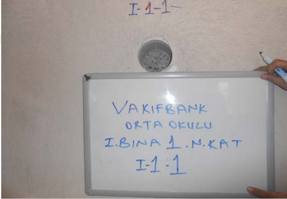
Şekil 4.23 Binadan Beton Numune Alınması
