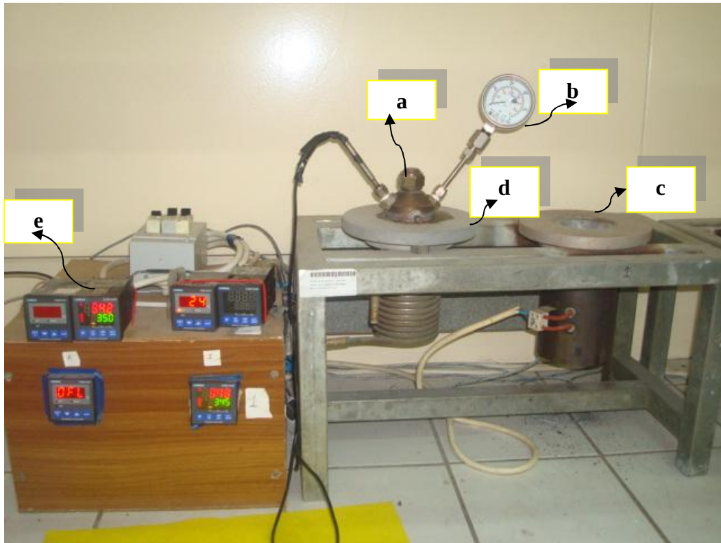
Şekil 3.1. Deneylerde kullanılan reaktör ve ısıtma-soğutma sistemi a: Reaktör, b: Basınç göstergesi (Gauche), c: Isıtma bölmesi d: Soğutma bölmesi, e: Sıcaklık göstergesi
