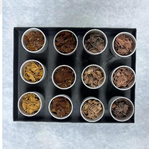
Şekil 3.2. Asit ile aktive edilmiş ham antep fıstığı kabuklarının piroliz işlemine tabi tutulmadan önceki görüntüsüne ait bir görsel
