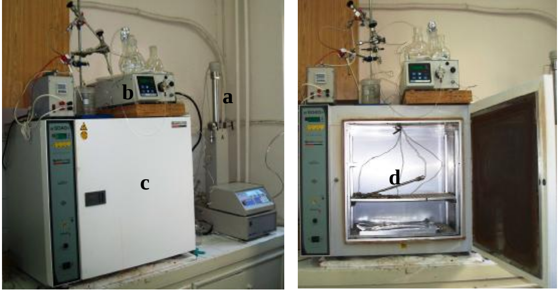
Şekil 3.1. sub ve süperkritik akışkan ekstraksiyon sistemi ( a: ISCO pompa; b: HPLC pompası; c: Fırın; d: Ekstraksiyon hücresi)
